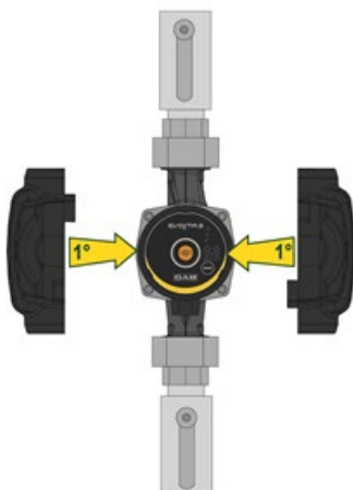
Рисунок 7: Изоляция корпуса насоса
