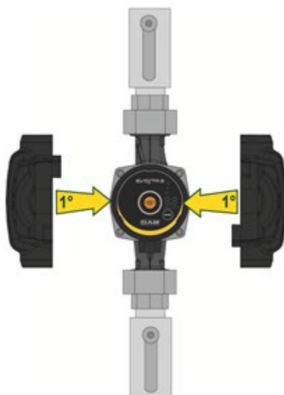
Fig 7: Isolering av pumphuset
