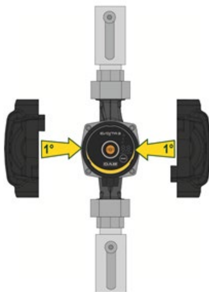
Figura 7: Aislamiento del cuerpo de la bomba
