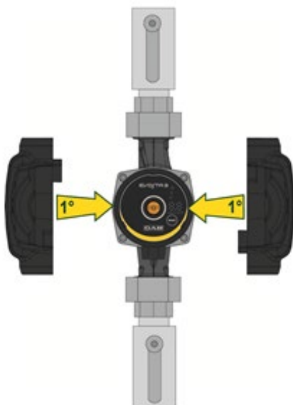
7. ábra: A pumpatest elszigetelése
